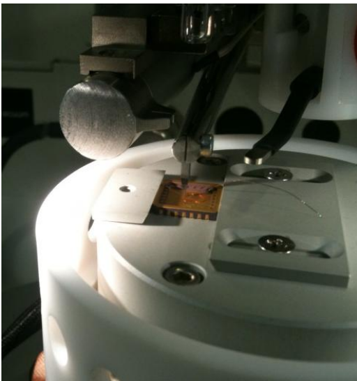
Wedgetool in Transducer beim Bonden
